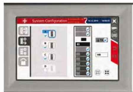
Сенсорный ЖК-экран MPW: удобное для пользователей отображение конфигурации и мониторинга ИВП.
